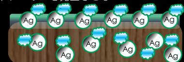
木材の特徴である毛細管現象を利用しナノシルバーを木材の奥深くまで運び留める事によって木材の内部から表層まで防腐効果を発揮する次世代の含浸型塗料です。
